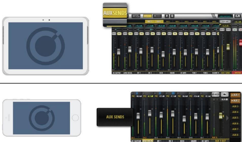
AUX SEND 画面では、モニター出力や外部 FX センド用に AUX ミックスを作ることができます。本製品には専用の出力端子が搭載されています。AUX フェーダーはオレンジ色のレベルメーターを持ち、AUX バスへの出力レベルを表します。Ui12 は 4 つの AUX バス、Ui16 は 6 つの AUX バスを搭載しています。SETTINGS の中で、HEADPHONES OUT オプションが AUX に設定されていた場合、Ui12 は 3/4 チャンネル、Ui16 は 5/6 チャンネルが AUX 出力端子へ出力されます。AUX バスに接続されている全てのチャンネルを表示するには、チャンネルの EDIT ページから AUX SENDS 画面を選びます。
